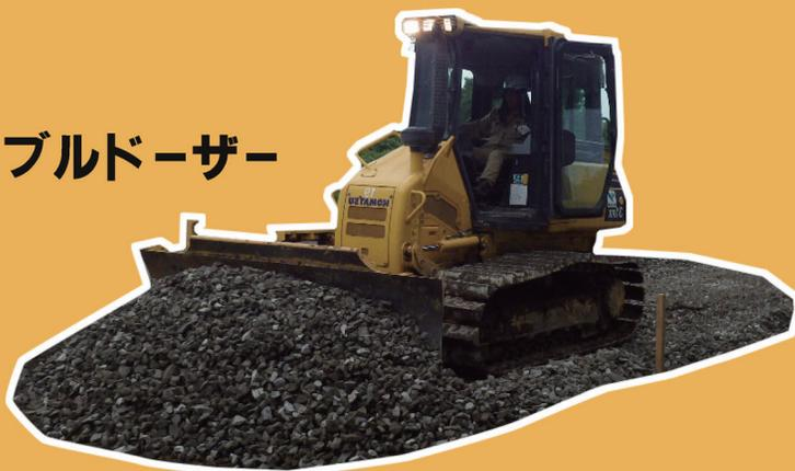
トラクターの前にブレードといった地面をならすための排土板を備えた建設機械。ブレードの刃を地面に垂直にして土砂を押ししたり、地面を平らにしたりします。ベルト状になっている足回りはクローラーと呼ばれています！クローラーだと地面との設置面積が大きいため、安定して踏ん張る力も強くなります。ブルドーザーの中には水陸両用のものもあります！
