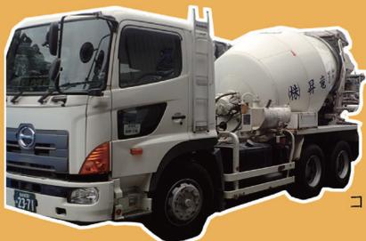
荷台部分に円筒状のドラムを備えたトラックのことです。ドラムの中には生コンクリートを入れて運んでいます。コンクリートが分離しないようにするため回転させています！
